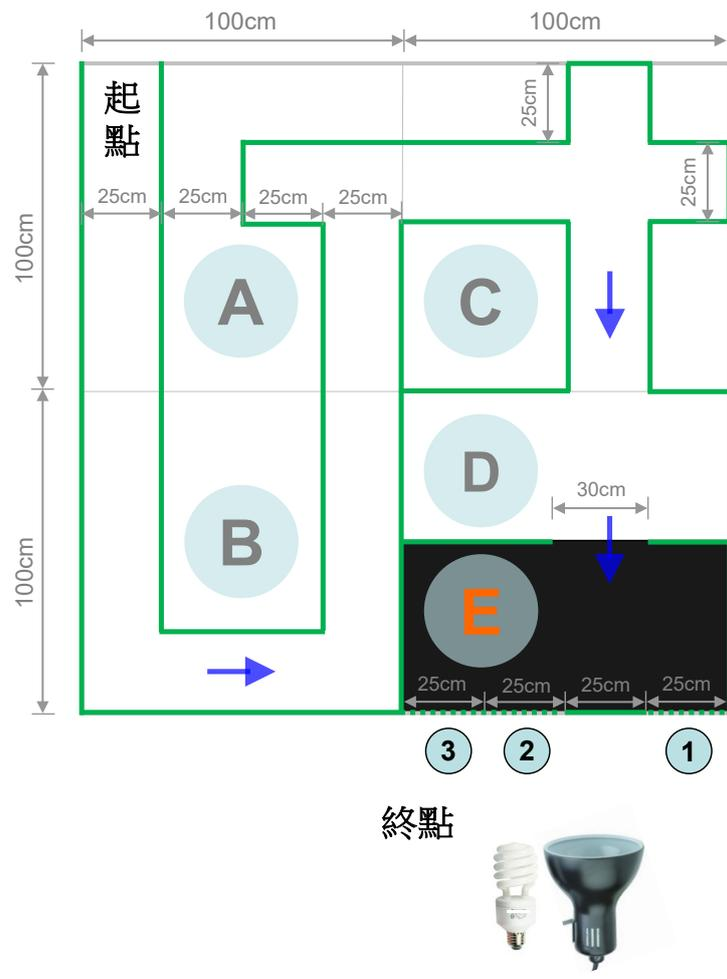
4. **大專組** 競賽場地：綠色實線-圍牆；綠色虛線-可能封閉之出口；黑色實線-導引線(寬約1.8cm 黑色電工膠帶)；黃色圓形-600ml 寶特瓶(不裝瓶蓋倒立放置)；黑色區塊-暗室；場地尺寸 300cm×200cm。
